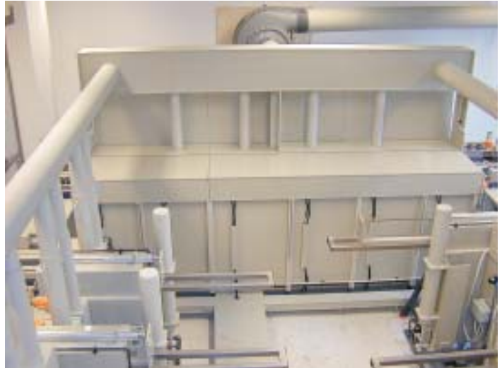
links - konventionelle, vertikale Vorbehandlung: kurze Warenstangen ermöglichen kompakte Badwannen rechts: Blick auf den Galvanotunnel: die Platten werden quer durch die Galvanozellen geschleust
