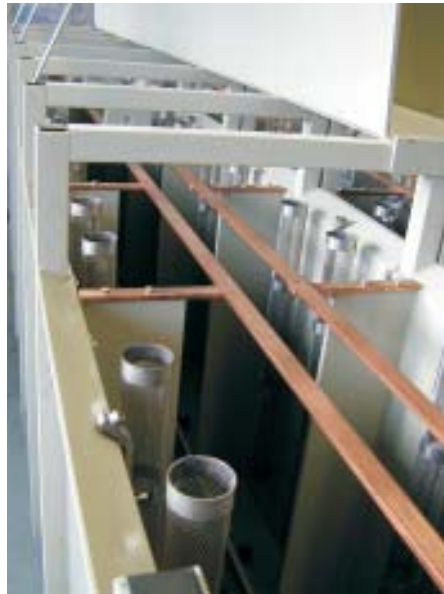
die Unterniveauekontaktierung der Titan-Anodenkörbe ermöglicht einen fehlerfreien Stromfluss
