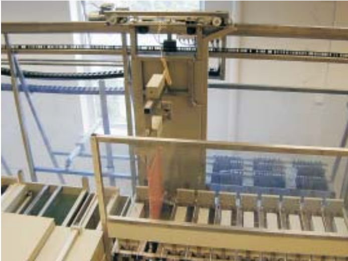
links - konventionelle, vertikale Vorbehandlung: kurze Warenstangen ermöglichen kompakte Badwannen rechts: Blick auf den Galvanotunnel: die Platten werden quer durch die Galvanozellen geschleust
